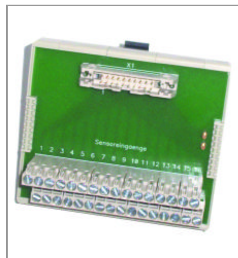
Übergabemodul für 16 Kanäle mit 32 Schraubklemmen (Sensoreingänge) Ausgang: 20 poliger Pfostensteckverbinder
